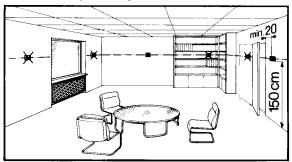
Термостат можно устанавливать как непосредственно на стену, так и в монтажные коробки.
