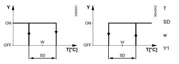
Комнатная температура Дифференциал переключения Уставка комнатной температуры Выходной сигнал "Отопление" или "Охлаждение"
